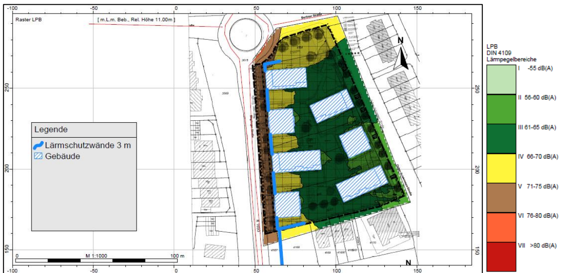
Plangebiet „Areal Überrück“ in Asperg, mit Lärmschutzwand 3 m, mit Bebauung Lärmpegelbereiche nach DIN 4109, Immissionshöhe 11 m ü. Gelände (DG)
